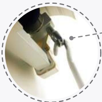
**INSTALACIÓN O ANCLAJE DE LA MANIVELA EN EL DIFERENCIAL TOSCANY.**
